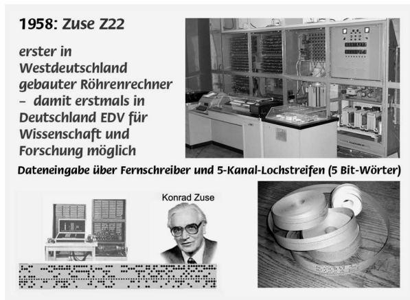
Abbildung 7. Deutscher Röhrenrechner Zuse Z22
